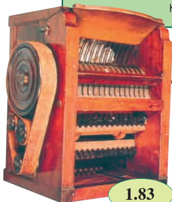
Η εκκοκκιστική μηχανή που έφτιαξε ο Αμερικανός Ίλι Χουίτιν. Η μηχανή αυτή βοήθησε να αναπτυχθεί πολύ η βαμβακοβιομηχανία στις νότιες πολιτείες των ΗΠΑ.
